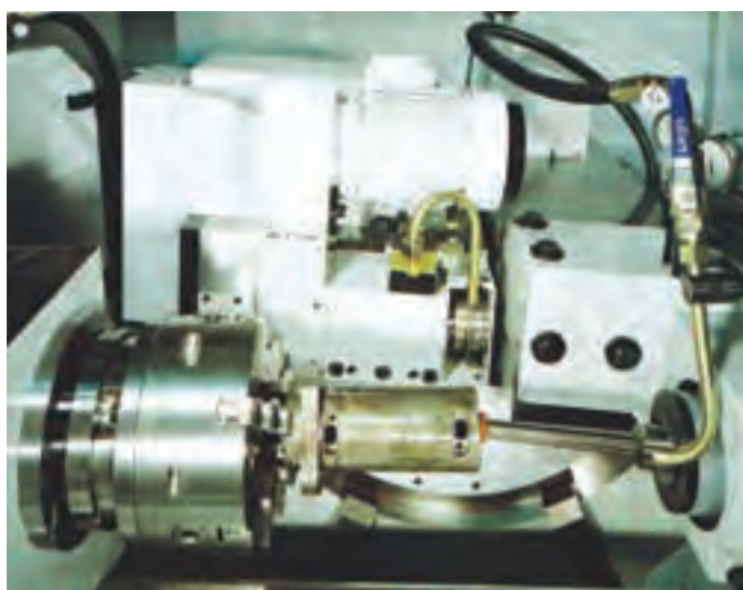
Fase di rettifica interna chiocciola/ Internal grinding of the nut
