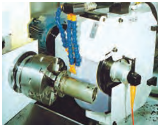
Fase di rettifica esterna/ External grinding of the nut
